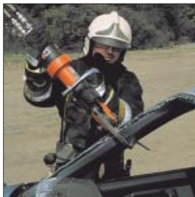
Enlèvement du toit.
