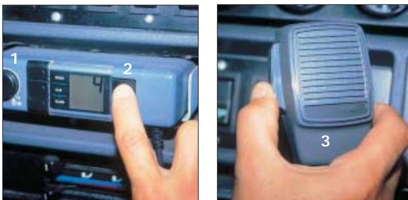
Légende: 1. Interrupteur et réglage du volume; 2. sélecteur; 3. micro
